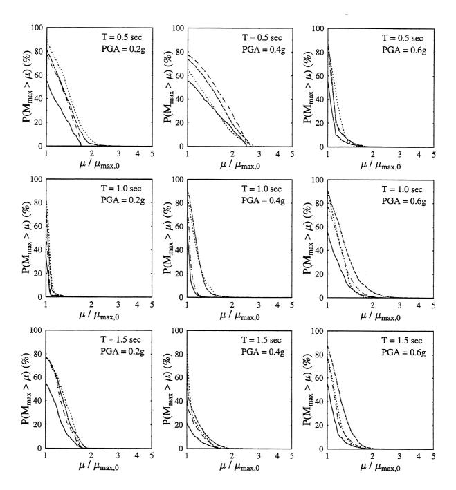
FIGURE 3-21 Probability of  $M_{\rm max}$  exceeding  $\mu_{\rm max,0}$ . EP model. Input: Taft. (——  $\rho=1;$  · · · · ·  $\rho=0,$   $\gamma=0.5;$  - · · · ·  $\rho=0,$   $\gamma=1.0;$  - · - ·  $\rho=0,$   $\gamma=1.5)$
