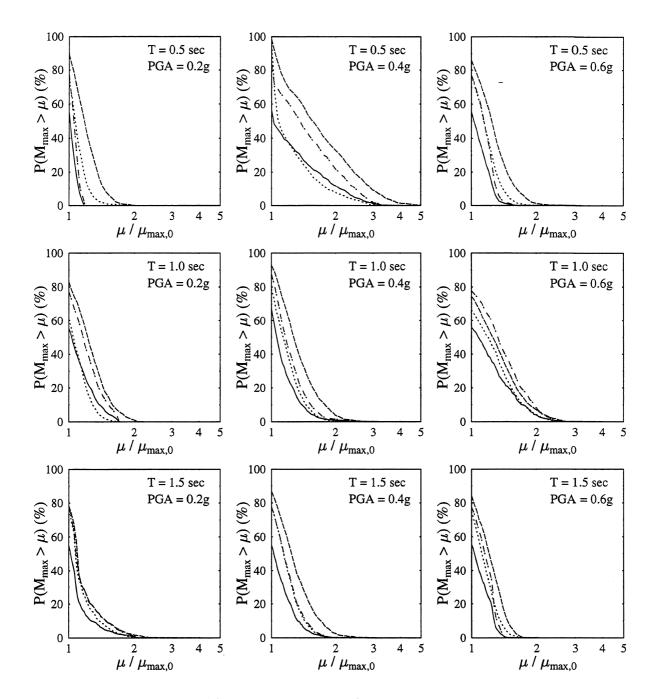
FIGURE 3-20 Probability of  $M_{\rm max}$  exceeding  $\mu_{\rm max,0}$ . EP model. Input: El Centro. (——  $\rho=1;$  ……  $\rho=0,$   $\gamma=0.5;$  …  $\rho=0,$   $\gamma=1.0;$  ——  $\rho=0,$   $\gamma=1.5)$
