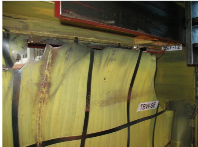
(b) Typ. Infill Web Plate Tearing
