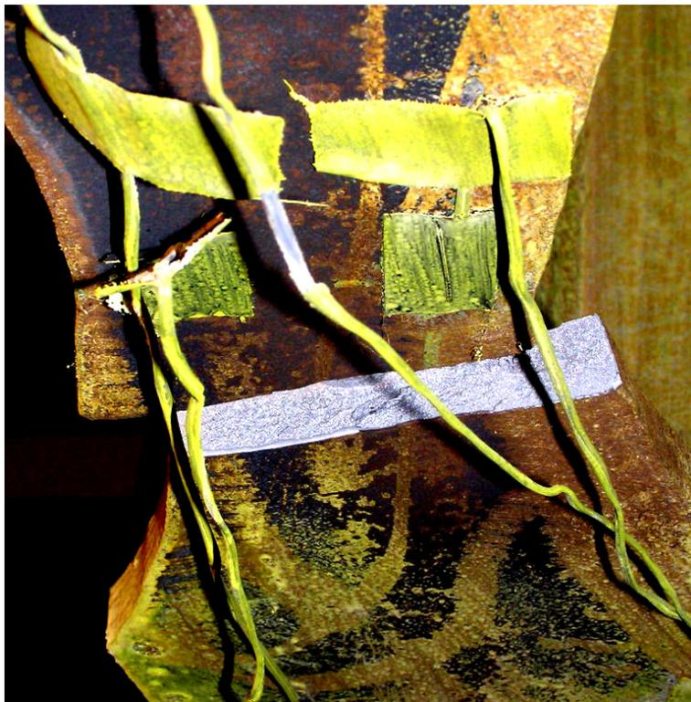
(d) Bottom flange rupture from below
