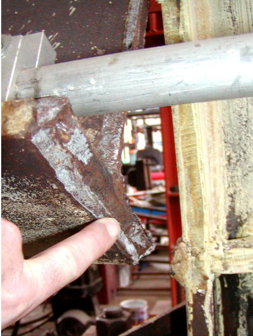
(d) Lack of weld fusion to beam flange
