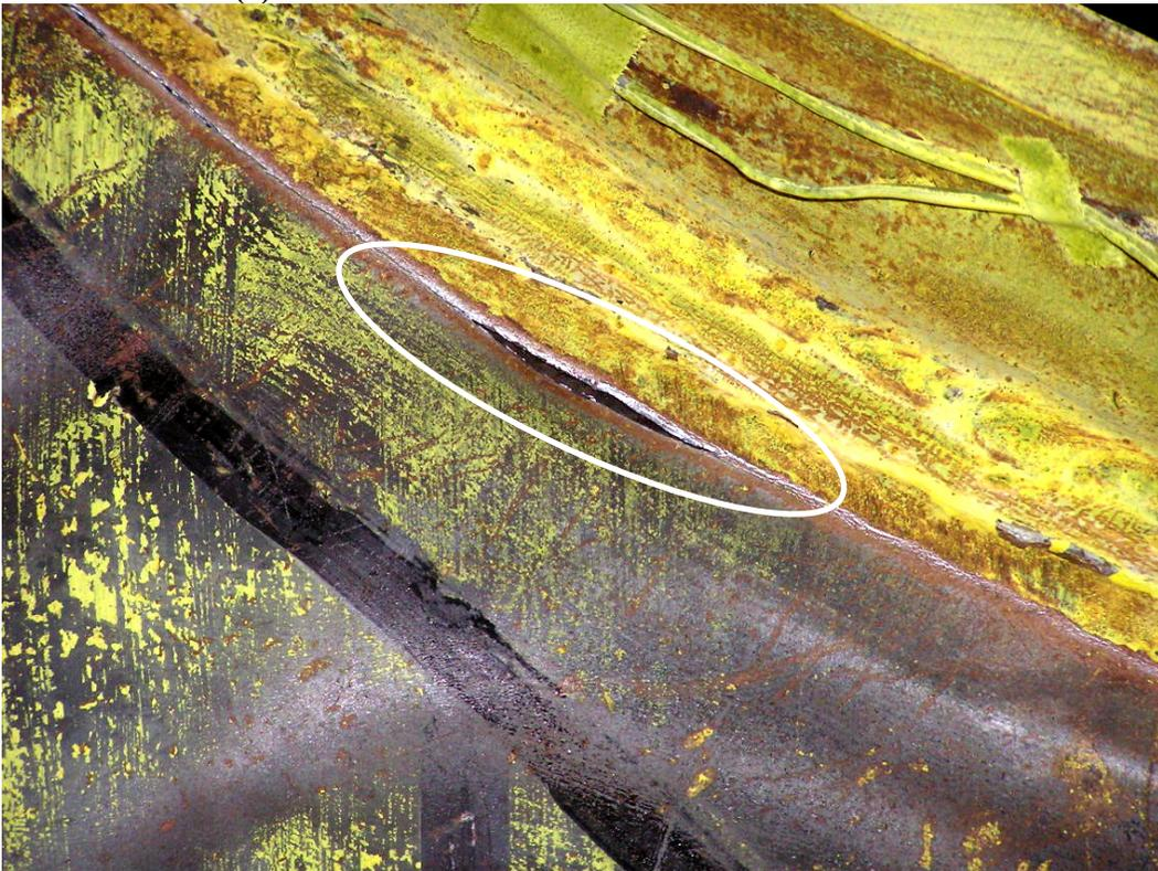
(d) Tearing of panel at far arch weld
