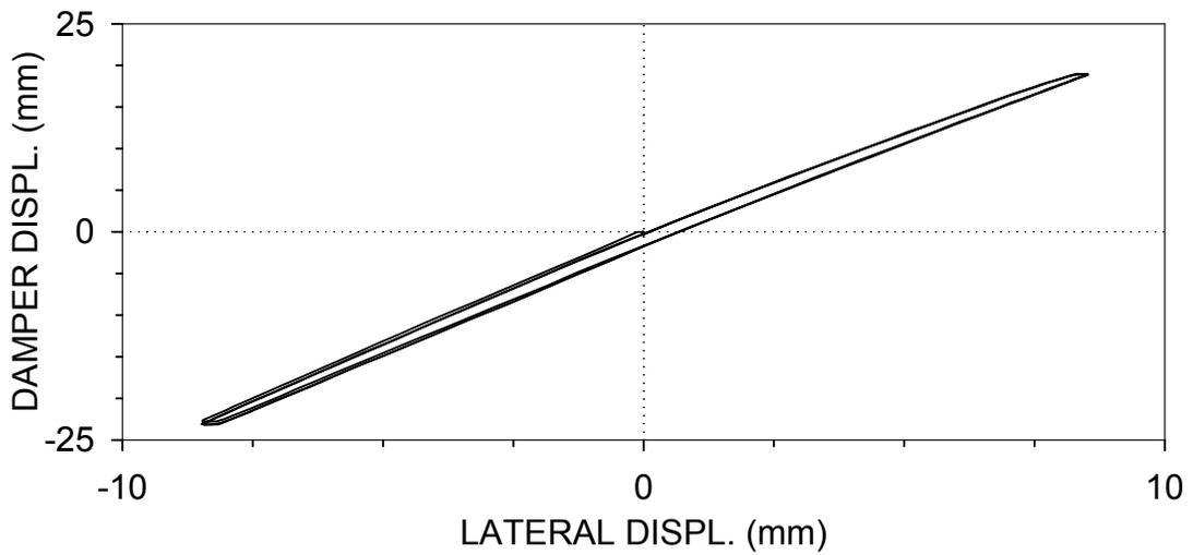
F2RS09 : BRACE 2, RIGID-SIMPLE CONNECTIONS
