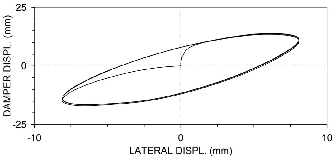
F2RS14 : BRACE 2, RIGID-SIMPLE CONNECTIONS
