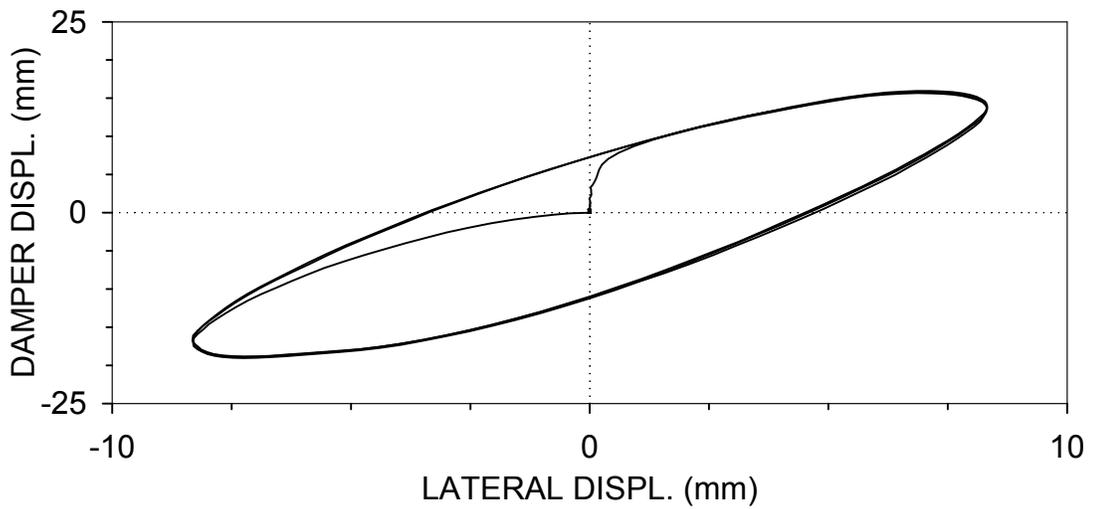
F2RS13 : BRACE 2, RIGID-SIMPLE CONNECTIONS
