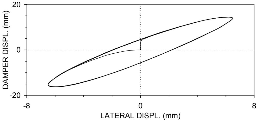
F1RS06 : BRACE 1, RIGID-SIMPLE CONNECTIONS
