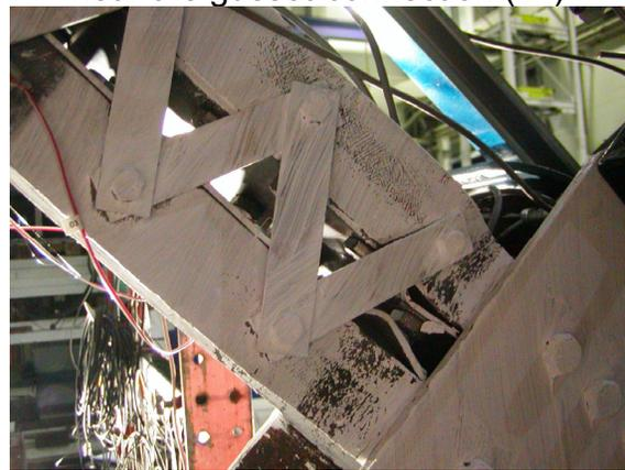
(d) Local buckling on the plates at  $\delta=0.24''(6.1\text{mm})$ , 1<sup>st</sup>
