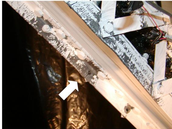
(d) Initial fracture at  $\delta=0.84''(21.3\text{mm})$
