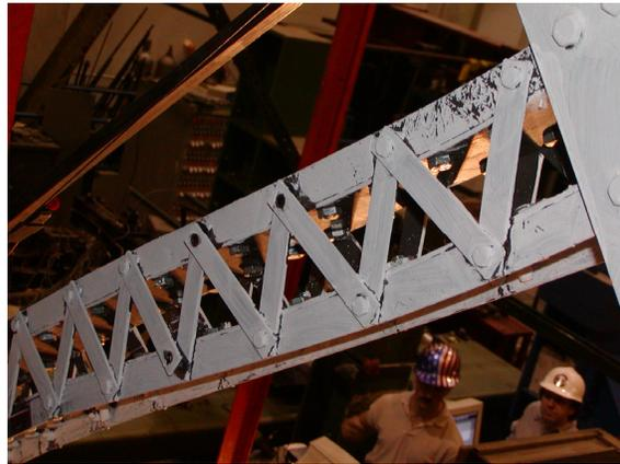
(d) Lacing bolt failures at  $\delta=0.24''$  (6.1mm)
