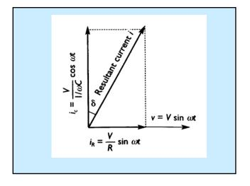
$$i_{c} = \frac{V}{1/\omega C} \sin\left(\omega t + \frac{\pi}{2}\right) ,$$
